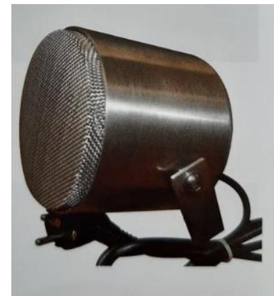
**Montage:** Der Abstand zwischen den Signalgebern sollte zwischen 4 und 15 Metern sein. Bei größeren Abständen sind mehrere Signalgeber in der Flucht anzuordnen, wobei immer 2 Signalgeber gegenüber montiert werden. Sollte zur Montage eine 2. Drehachse erforderlich sein, so wird dies erreicht, wenn der Montagebügel an einem runden Teil, z.B. Blitzschutzdraht, befestigt wird.
